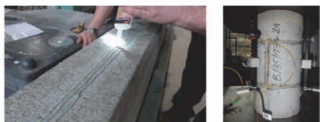
Rys. 20. Światłowód przyklejony do powierzchni belki żelbetonowej i betonowego walca przygotowanego do próby ściskania.
