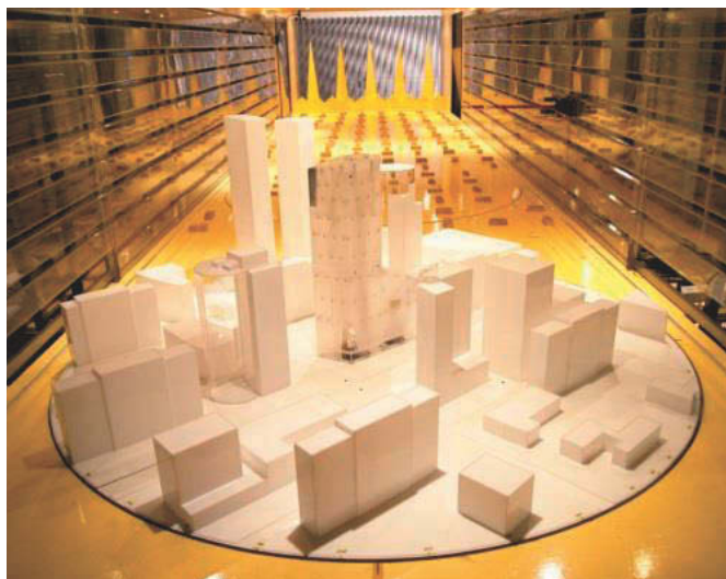
Rys. 11. Badania modelowe w tunelu aerodynamicznym i analizy studialne oddziaływań wiatru dla projektowanego budynku wysokościowego u zbiegu al. Jana Pawła II i ul. Grzybowskiej w Warszawie, Kraków 2013.
