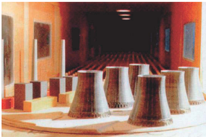
Rys. 6. Model chłodni kominowych i sąsiadującej zabudowy (budynek i kominy elektrociepłowni) do badań rozkładów ciśnienia wiatru na ścianach chłodni, z uwzględnieniem zjawisk interferencji aerodynamicznej – tunel aerodynamiczny Uniwersytetu w Rio Grande do Sul (Brazylia)
