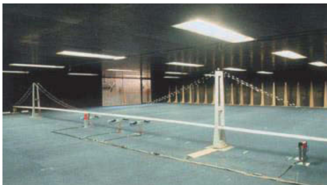
Rys. 7. Model aeroelastyczny głównego przęsła mostu wiszącego (Great Belt East Bridge) w tunelu aerodynamicznym im. Martina Jensena w DMI Lyngby (Dania)
