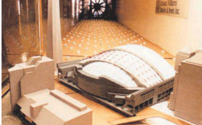
Rys. 5. Model stadionu sportowego z nietypowym ruchomym przekryciem (Sky Dome), wraz z sąsiadującą zabudową, do badań rozkładu ciśnień wiatru na przekryciu – tunel aerodynamiczny RWDI w Guelph (Ontario, Kanada)
