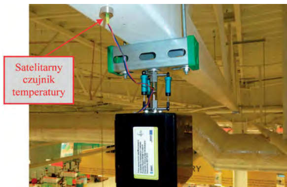
Rys. 1. Urządzenie pomiarowe z dalmierzem laserowym
