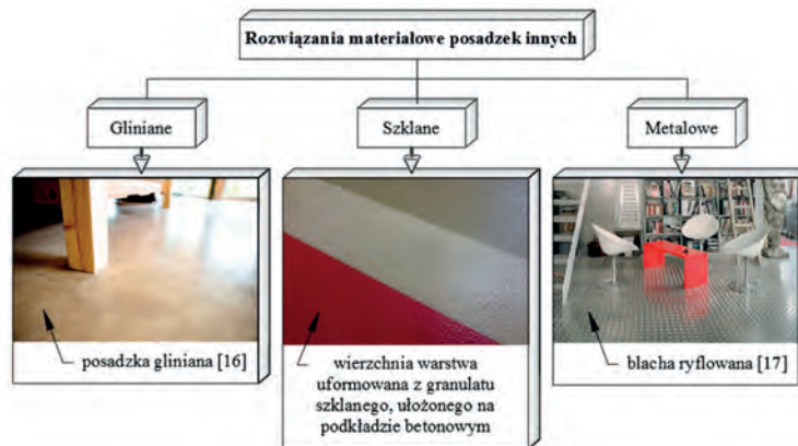
Rys. 7. Rozwiązania materiałowe posadzek innych Fig. 7. Material solutions of others flooring
