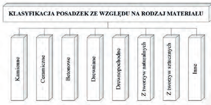
Rys. 1. Klasyfikacja posadzek ze względu na rodzaj materiału Fig. 1. Classification of flooring considering to the type of material
