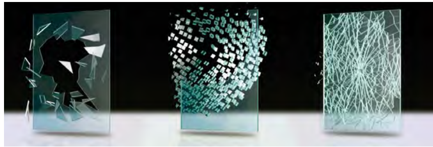
Rys. 2. Obraz po pęknięciu szkła (od lewej) zwykłego typu float, hartowanego, laminowanego [5]
