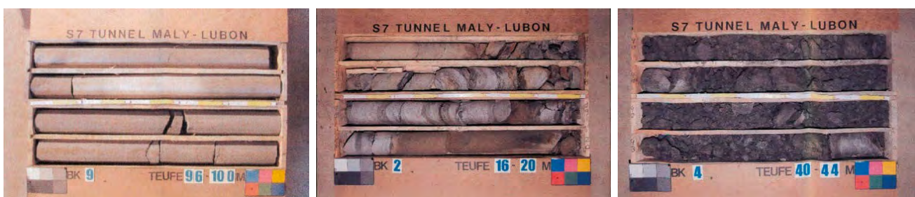
Rys. 4. Rdzenie wiertnicze i odpowiadające im kategorie odpowiedzi mechanicznej się przodka: stateczność przodka; tymczasowa stateczność przodka; brak stateczności przodka [3]
