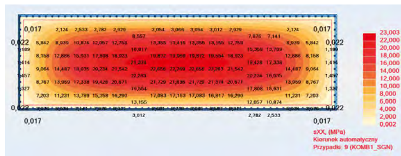
Rys. 3 Naprężenia – szyba GL 2 1430 x 4900 (66.2); kombinacja obciążeń: ciężar własny (wsp. bezp. 1,10), siła pozioma (wsp. bezp. 0,66), parcie wiatru (wsp. bezp. 1,10), ssanie wewnętrzne (wsp. bezp. 0,66), ciśnienie izochoryczne (wsp. bezp. 0,66), źródło: archiwum własne autora – dokumentacja projektowa
