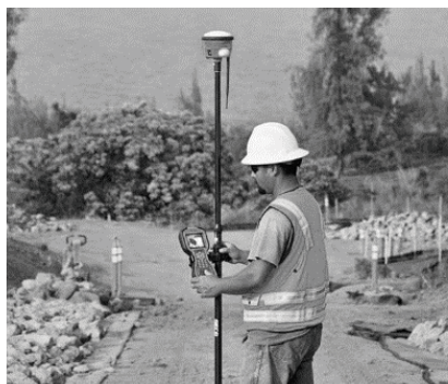
Rys. 2. Tyczka pomiarowa GNSS z kontrolerem [19]
