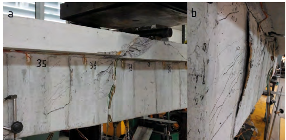
Rys. 3. Zniszczenie belki: a) ukośna rysa niszcząca, b) odspojenie paska PBO i zarysowanie zakotwienia
