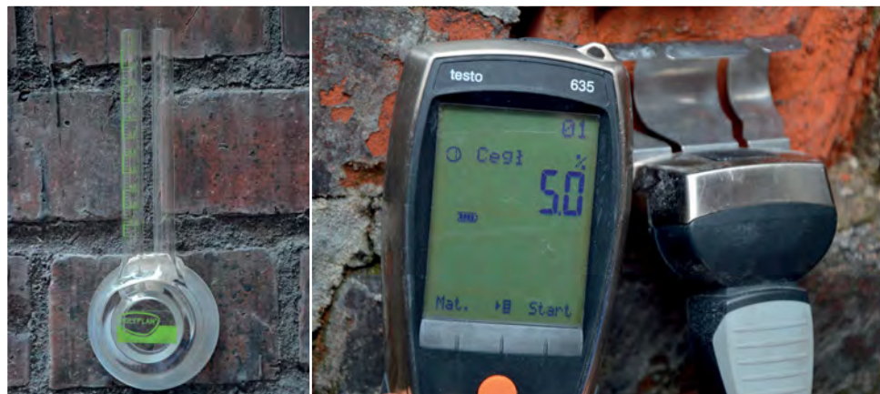
Rys. 7, 8. Rurka Pleyersa i pomiar wilgotności masowej ścian (5)
