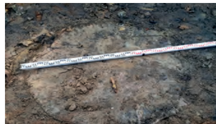
Rys. 1. Przykład odświeżenia kolumny – pomiar średnicy kolumny pionowej [5]
