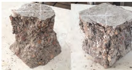
Rys. 3. Obraz zniszczenia ściskanej próbki betonowej (z lewej) i fibrobetonowej (z prawej)
