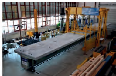
Rys. 4. Przekrój poprzeczny dźwigara hybrydowego (z lewej) oraz pełnowymiarowy dźwigar na stanowisku badawczym (z prawej)
