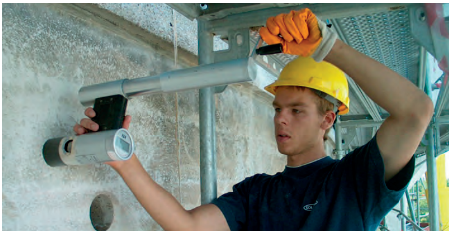
Rys. 4. Przykład realizacji pomiarów metodą „pull-out” Fig. 4. Example of execution of the “pull-out” test
