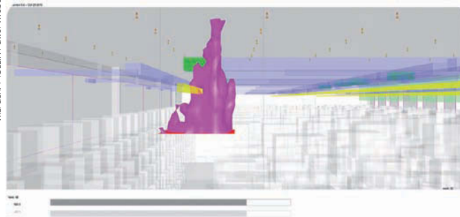
Wizualizacja obliczeń CFD z uwzględnieniem działania tryskaczy do oceny odporności ogniowej konstrukcji stalowej
