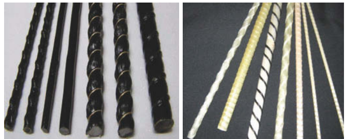
Rys. 2. Pręty niemetaliczne zbrojenia konstrukcyjnego: a) z włókien bazaltowych BFRP, b) z włókien szklanych GFRP
