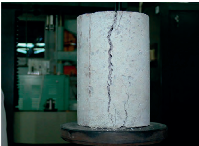
Rys. 6. Sposób zniszczenia próbki betonowej podczas wyrywania pręta \varnothing 10 z betonu C25/30 w warunkach normalnych 20°C (z lewej) oraz po nagrzaniu do temperatury 700°C i ostudzeniu do 20°C (źródło: opracowanie własne)
