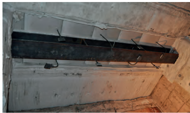
Rys. 4. Schemat statyczny badanej belki stalowej oraz widok elementu próbnego przed badaniem (źródło: archiwum ITB)
