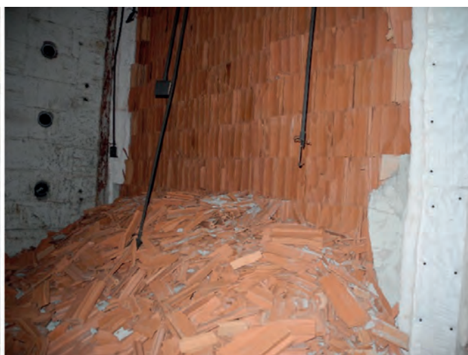
Rys. 7. Zniszczenie ściany z pustaków o dużych drążeniach podczas badania odporności ogniowej (obliczeniowo REI 240, weryfikacja badawcza REI 45), z prawej: sposób „luszczenia” kolejnych warstw pustaków o dużej ilości małych drążań, widok po badaniu (źródło: archiwum ITB)
