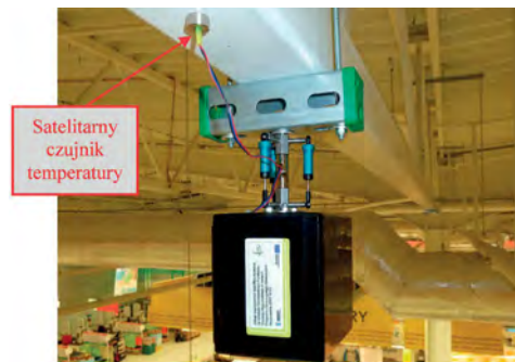
Rys. 2. Urządzenie pomiarowe z dalmierzem laserowym
