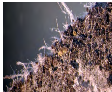
Fot 1 i 2. Azbesto-cement. Z lewej: Powierzchnia płyty falistej azbestowo-cementowej pokrycia dachowego, w dole fali widoczne słabo związane z matrycą cementową niebieskie włókna azbestu krokidolifowego, które odsłoniły się po wyptukaniu spoiwa cementowego. Po prawej: Gąbczasta struktura płyty azbestowo-cementowej pokrycia dachowego, powstała wskutek wieloletniej eksploatacji i działania deszczów. Widoczne w przelamie białe włókna to chryzotyl. Wskutek rozpuszczenia spoiwa nastąpił na powierzchni wzrost zawartości azbestu w produkcie z ok 12% do ok 20%.
