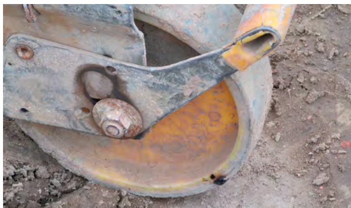
Widoczne ślady oddziaływania łuku elektrycznego na kole rusztowania przejezdnego
