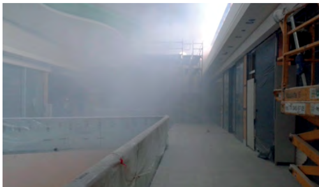
Fot. 1. Widok zadymienia podczas próby z gorącym dymem w pasażu centrum handlowego
