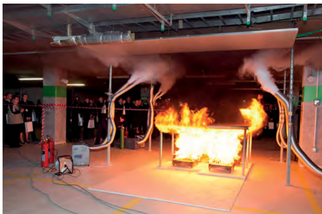
Fot. 4. Próba z gorącym dymem w garażu, moc źródła pożaru około 1 MW. Widoczne zabezpieczenie tryskacz
