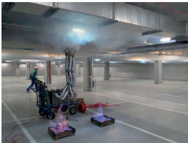
Fot. 2. Próba z gorącym dymem w garażu
