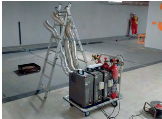
Fot. 7. Widok gotowego zestawu do generacji gorącego dymu
