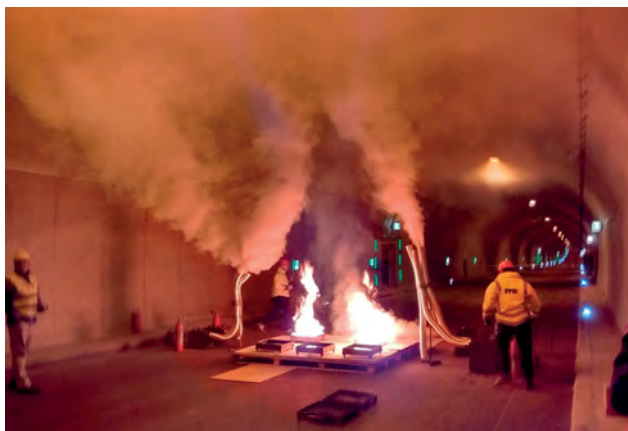
Fot. 3. Próba z gorącym dymem w tunelu drogowym, moc źródła pożaru około 1,5-2 MW
