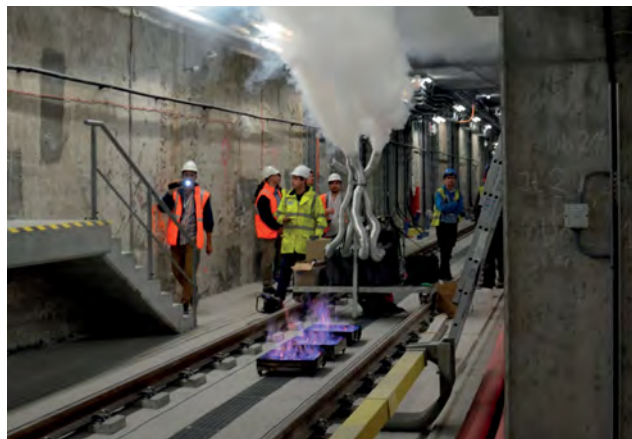
Fot. 8. Próba z gorącym dymem w tunelu metra
