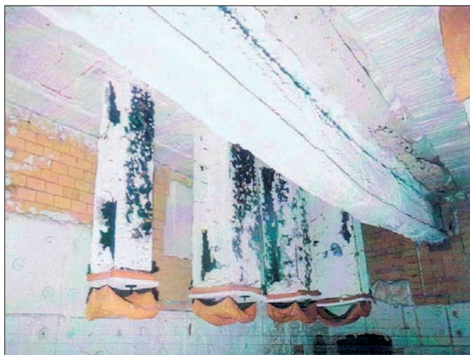
Rys. 9. Farba pęczniająca po badaniu (ITB)
