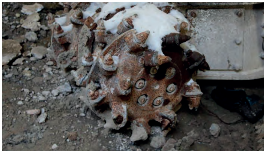
Rys. 3. Głowica frezująca do odpajania zmarzniętego gruntu [3] Milling head for digging frozen ground.
